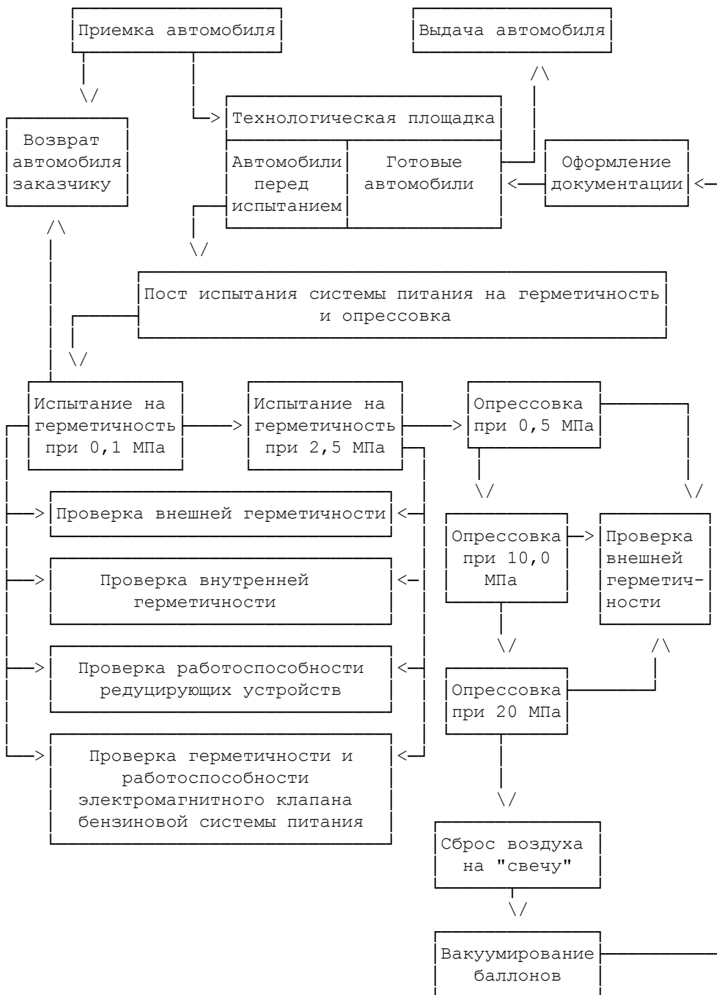
Рис. 9.1. Технологическая схема испытаний автомобилей, работающих на КПГ
