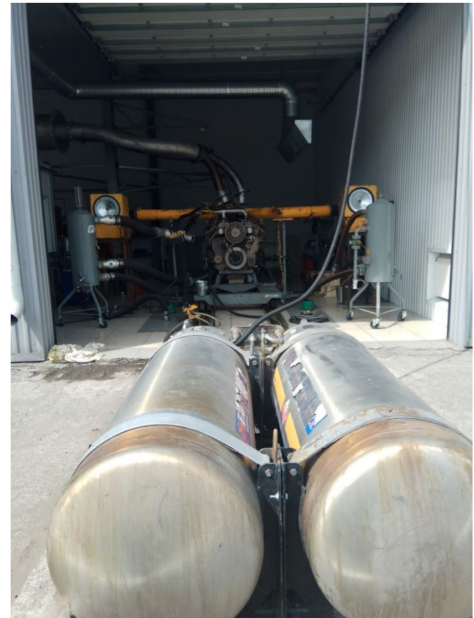
Калибровка газодизельной версии двигателя KTA50 на моторном стенде г. Новокузнецк
