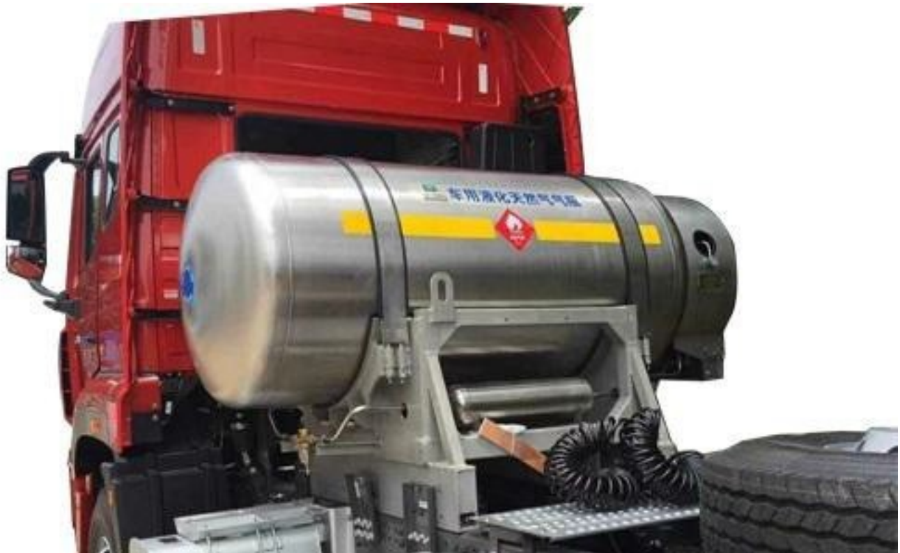
Рис. 2 Изолированный автомобильный бак для СПГ из нержавеющей стали, установленный в передней части шасси. При необходимости баки для СПГ разной емкости могут быть установлены в разных местах.
